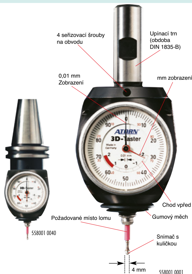
Když je malý a velký ukazatel na „nule“, potom je osa vřetene rovná ose dotyku. Řízení stroje se vynuluje.
