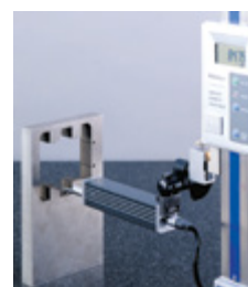
Vložka s výškoměrem 5305020300 pomocí adaptéru 5705310016
